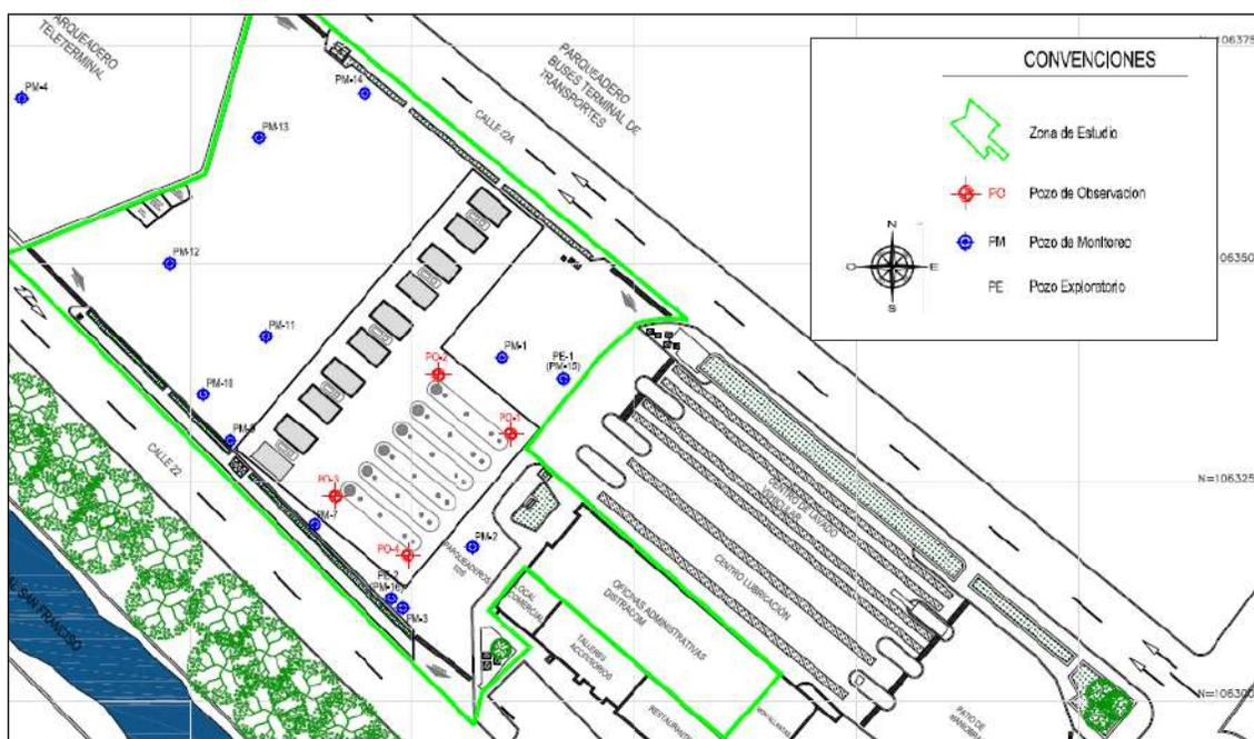
**Figura 3. Plano del predio con las perforaciones - pozos de monitoreo instalados**
